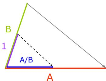
*Dibujemos un triángulo con 2 lados de longitudes A y B, y dibujemos un triángulo semejante cuyo lado correspondiente a B tenga longitud 1, entonces su lado correspondiente a A tendrá longitud A/B.*
