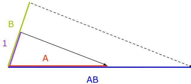
*Dibujemos un triángulo con dos lados de longitudes A y 1. Luego dibujemos un triángulo semejante cuyo lado correspondiente a 1 tenga longitud B, entonces su lado correspondiente a A tendrá longitud AB.*
