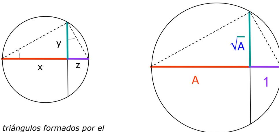
*Los triángulos formados por el diámetro de un círculo y una línea perpendicular son semejantes, así que  $x/y = y/z$  por lo tanto  $xz = y^2$*
