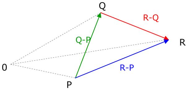
Las posiciones de los vértices del triángulo están dadas por 3 vectores P, Q y R, los vectores que unen a los vértices son  $Q-P$ ,  $R-Q$  y  $R-P$ .
