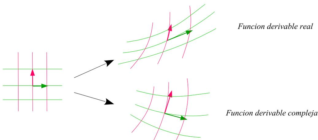
La derivada de  $f : \mathbb{R}^2 \rightarrow \mathbb{R}^2$  envía los vectores  $(1, 0)$  y  $(0, 1)$  a los vectores  $(\frac{\partial u}{\partial x}, \frac{\partial v}{\partial x})$  y  $(\frac{\partial u}{\partial y}, \frac{\partial v}{\partial y})$ . Las ecuaciones de Cauchy Riemann dicen que estos vectores son ortogonales y del mismo tamaño.
