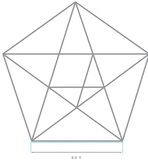
**Intersecciones:** Se traza un pentágono regular donde  $Y$  es la altura de la i capitular y el lado es igual a  $5y$ , se unen sus vértices y las intersecciones que se crean.
